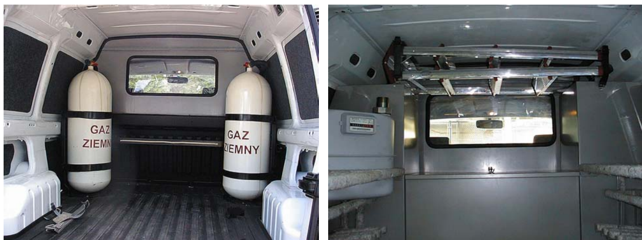
Rys 10 i 11 Peugeot Partner – zbiorniki CNG przed zamaskowaniem i po zabudowaniu
