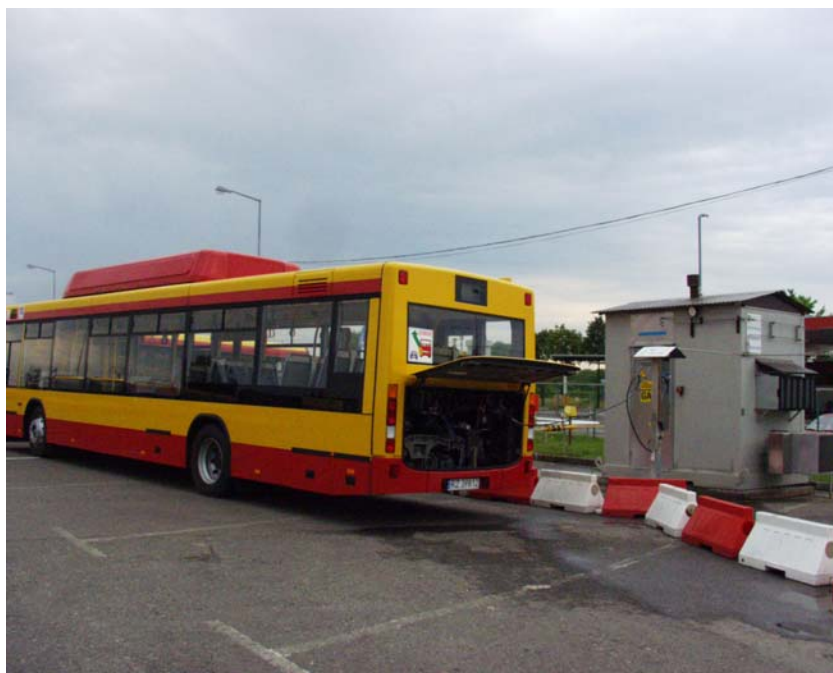
Rys 9. Jelcz CNG ze zbiornikami kompozytowymi na dachu w trakcie tankowania gazu ziemnego w Rzeszowie
