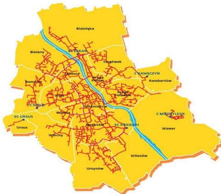
Rys. 1 Warszawski system ciepłowniczy
