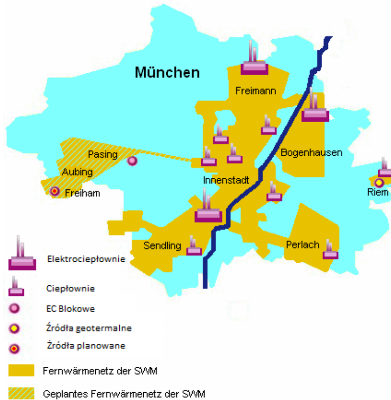
Rys. 4 Sieć ciepłownicza w Monachium (stan na rok 2009)
