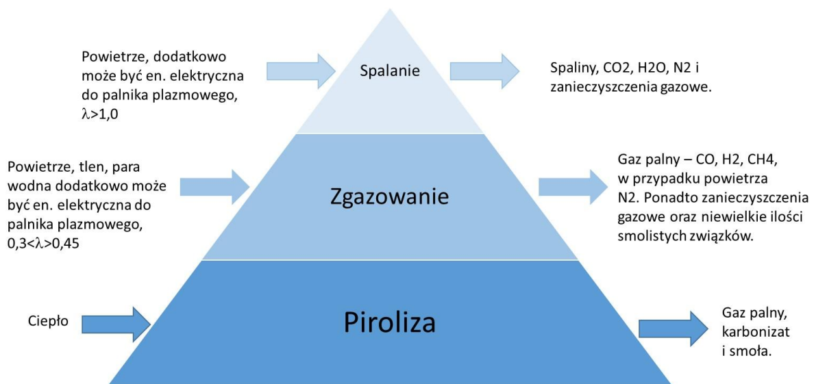
Rys. 2. Schemat różnych podstaw procesowych termicznych metod przekształcania odpadów
