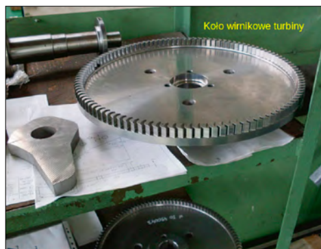
Rys. 10 Widok kół wirnikowych turbiny systemu Elektra (łopatki frezowane z materiału tarczy), według [10].
